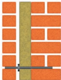
4. Укладывается тепло- изоляция
