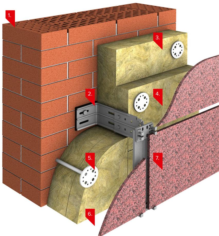
1. Несущая/самонесущая часть стен (кирпич, «легкие» блоки плотностью не ниже 800 кг/м<sup>3</sup>, монолитный железобетон)
