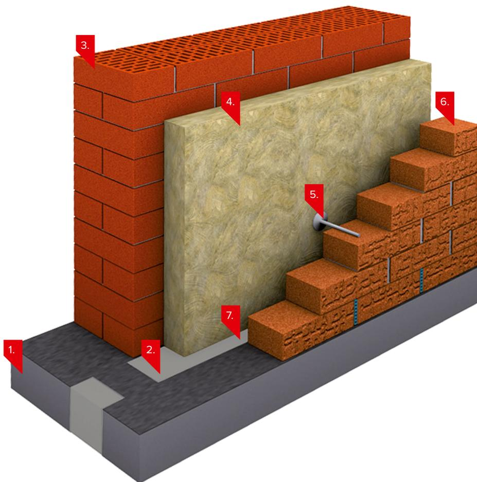
1. Опорное перекрытие с системой «термовкладышей»
