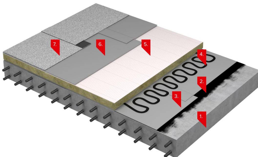
1. Железобетонная плита перекрытия
