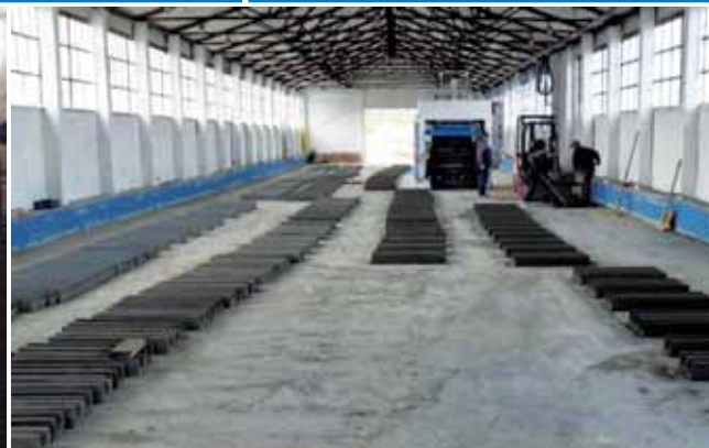
Производство бетонных лотков
