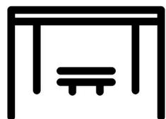
2. Хранение изделий должно осуществляться на ровной поверхности, в помещениях (или на площадках) без прямого воздействия солнца или дождя. Нужно обеспечить зазор между изделиями не менее 50 мм.
