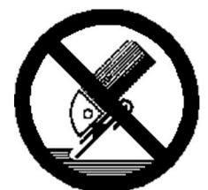
4. Рядом с местом хранения запрещено проводить сварочные работы, работы с углошлифовальной машинкой с абразивным кругом («болгаркой») и другие работы, которые могут повредить изделия. Стружка и искры, попадающие на поверхность изделий, могут повредить полимерное покрытие и привести к коррозии.
