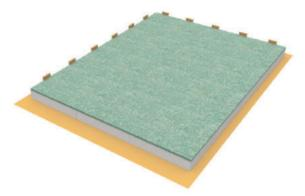
Укладка плит методом «плавающего пола» не требует жесткого крепления к основанию. В процессе монтажа все плиты расклиниваются для более жесткой фиксации. Клинья убираются через 24 часа после высыхания клея.
