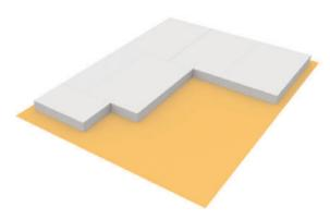
Укладка плит пенополистирола плотностью > 25 кг/м3 на сухое и выровненное основание. Стыки плит проклеиваются монтажным клеем.
