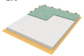
Укладка плит QUICK DECK на пенополистирол начинается от дальнего угла, противоположному входу. Между стеной и плитами необходимо оставлять зазор 5- 10мм. Стыки плит не должны совпадать со стыками пенополистирола. Аналогично плитам утеплителя, плиты QUICK DECK укладываются со смещением, не допуская образования перекрестных швов.
