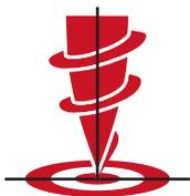
Во время вкручивания держите саморез в вертикальном положении. Если саморез будет вкручиваться под углом, то прокладка шайбы будет недостаточно плотно прилегать к поверхности кровли, и, таким образом, не будет достигнута водонепроницаемость соединения.
