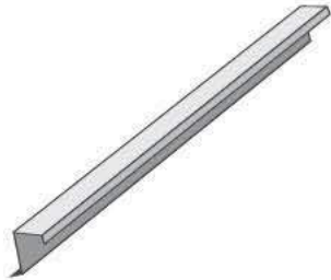
Торцевая планка Расход: 1,2 шт м.п Длина — 1350 мм Вес — 1,4 кг
