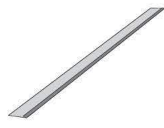
Стартовая планка Расход: 1,2 шт м.п Длина — 1355 мм Вес — 0,8 кг Без посыпки
