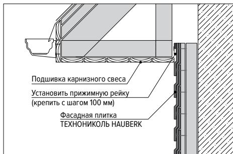
Рис. 9.1. Монтаж верхнего ряда под карнизным свесом
